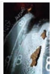
Figura 2 - Detalhe de uma região cavitada
