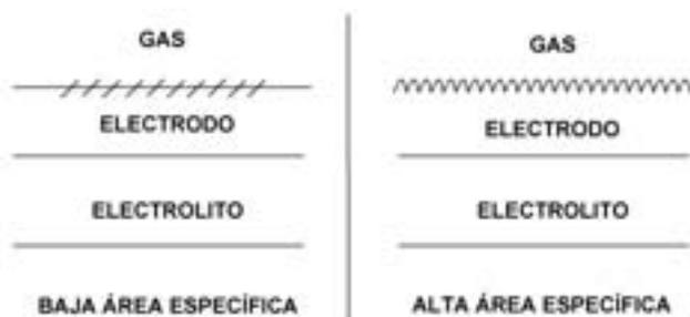
Figura 4. Puntos activos para las reacciones de electrodo, dependiendo de su área específica, en el caso del empleo de conductores mixtos como electrodo. Esto vale tanto para la oxidación del combustible en el ánodo como para la reducción del  $O_2$  en el cátodo.
