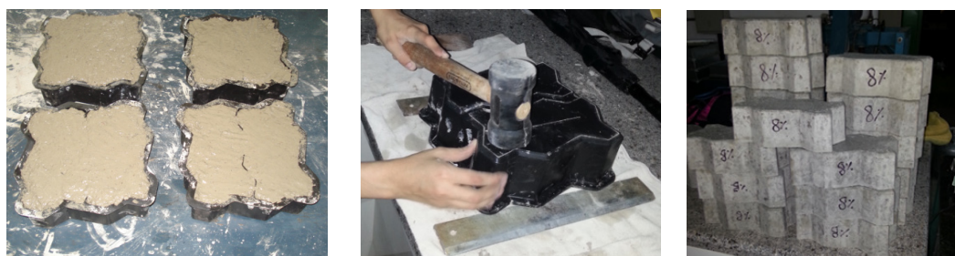
Figura 2 - Etapas do processo de confecção dos blocos de concreto intertravados
