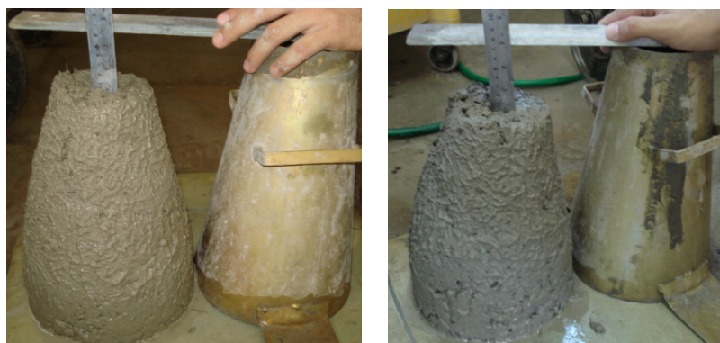
Figura 3 - Consistência pelo abatimento de tronco de cone
