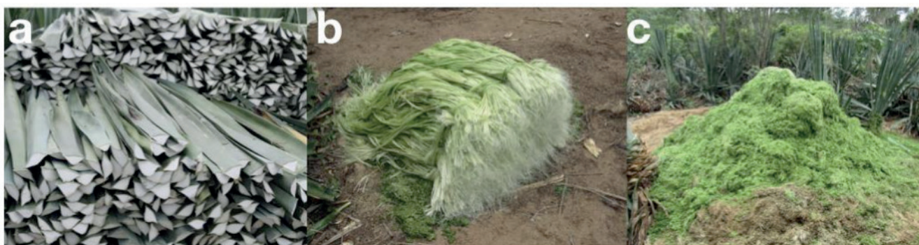
Figura 3: Diferentes estágios da produção de fibra. (a) Folhas cortadas. (b) Fibras após passarem pela desfibradeira. (c) Bagaço, que é 96% da folha. Fotos: Raya, F. T.
