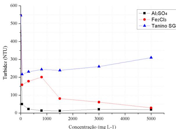
Observando-se a Figura 1, é possível verificar que o AS apresentou o melhor desempenho para redução do parâmetro de turbidez, uma vez que a turbidez residual diminuiu rapidamente. Com isso, a partir de dosagem de 300 mg L<sup>-1</sup> de coagulante foi alcançada a máxima redução possível, e o aumento adicional na dosagem de coagulante não proporcionou uma redução na turbidez residual significativa; o excesso de sais de alumínio são prejudiciais aos organismos humanos e vivos (GUO et al., 2015).
