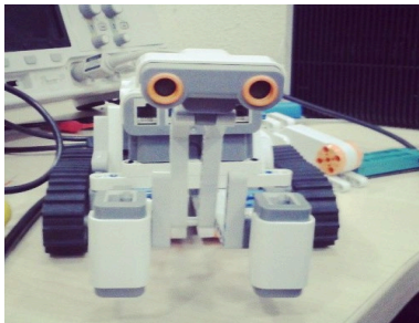
Figura 02: Estruturas básicas dos robôs desenvolvidas. (a) Robô com o LEGO Mindstorms® NXT. (b) Robô com o LEGO Mindstorms® EV3.
