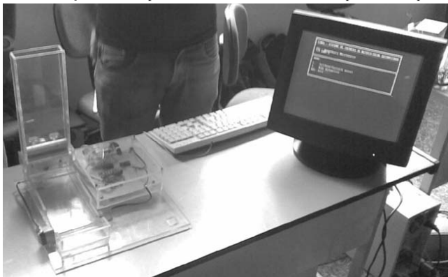
Figura 03: Sistema inserção de matéria prima (buffer de entrada) desenvolvido por alunos do primeiro semestre
