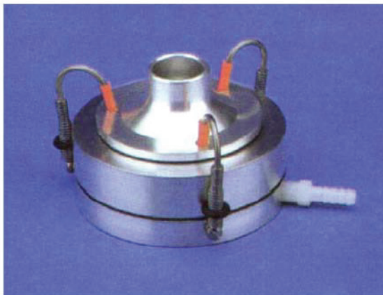
Figura 3 - Impactador Andersen de um estágio utilizado para amostrar bioaerossóis no ar entrando e saindo do reator de neblina ativada.
