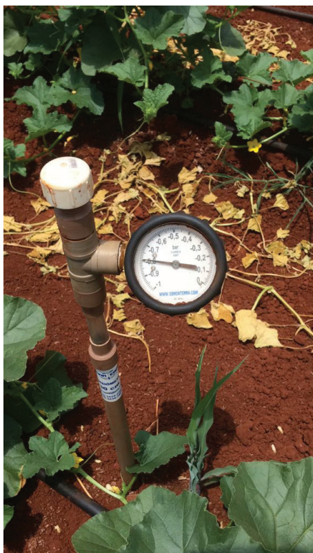
Figura 1 - Tensiômetro instalado na cultura do pepino.
