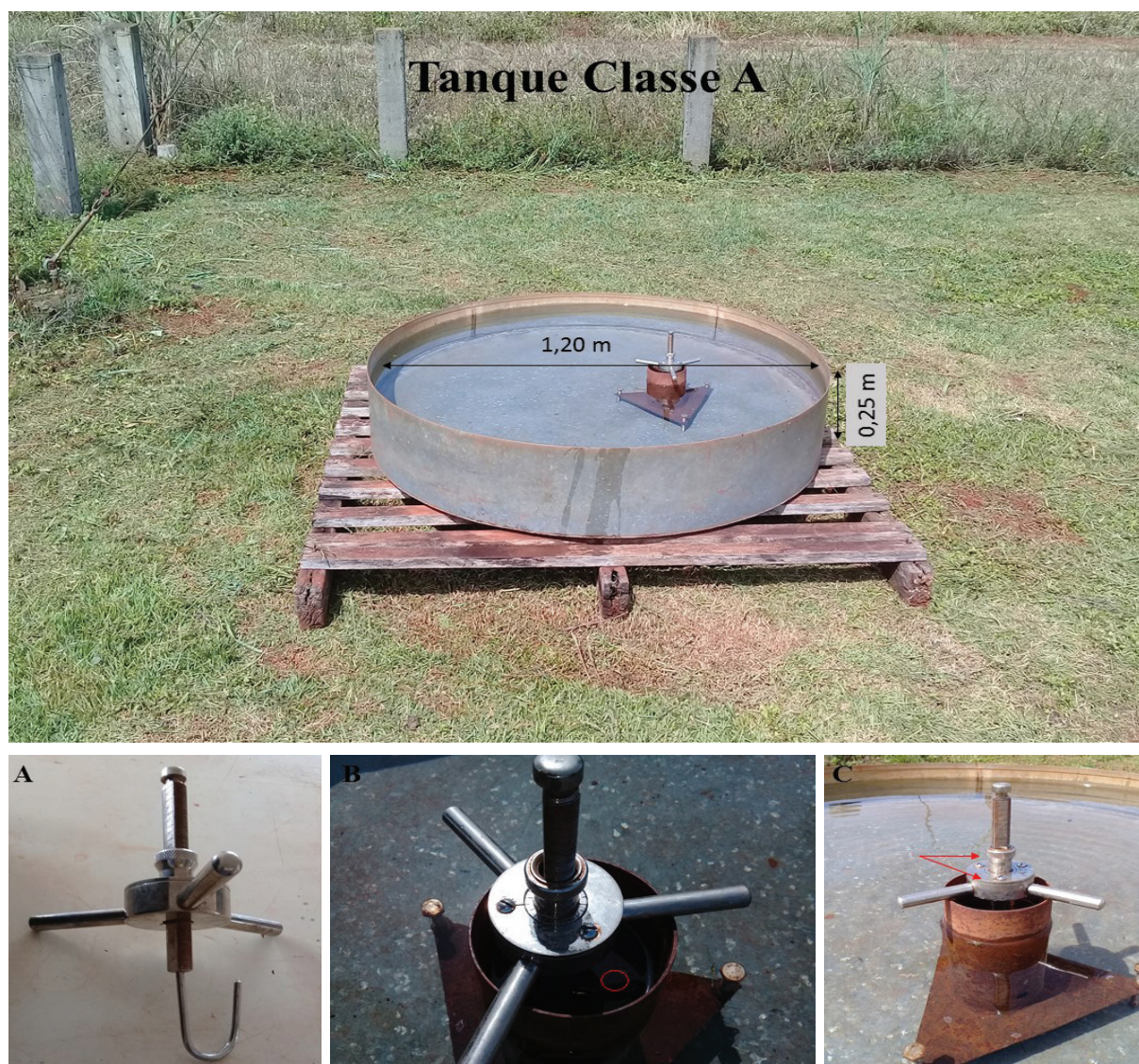
Figura 5 - Dimensões e instalações do Tanque classe A pertencente à Universidade do Estado de Mato Grosso – Tangará da Serra: A – Parafuso Micrométrico; B – observação da ponta na superfície da água; C – Leitura em milímetro com decimal.
