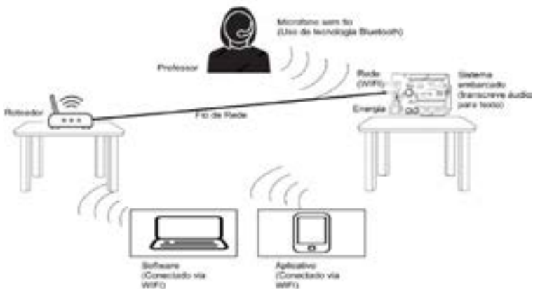
Figura 01. Proposta de arquitetura tecnológica para a transcrição de áudio para texto em tempo real
